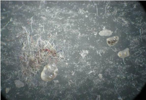
Bild 1: Mikroskopische Aufnahme eingeschleppter Sand- und Faserpartikel, die zur vorschnellen Zerstörung einer Bodenbeschichtung geführt haben.
